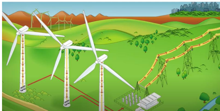
ภาพแสดงขั้นตอนการผลิตไฟฟ้าจากโรงไฟฟ้าพลังงานลม
